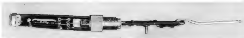
Bild 33. Innenaufbau des Tastkopfes
